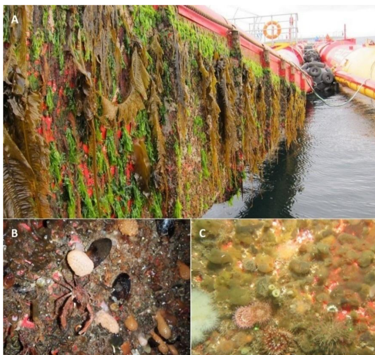
Figura 15. A) Algas colonizando el lateral del convertidor de energía del oleaje Pelamis P2; B) biofouling presente a una profundidad de ~0,5-2 m; C) parte inferior del dispositivo Pelamis P2 (figura obtenida de Nall et al., 2017).
