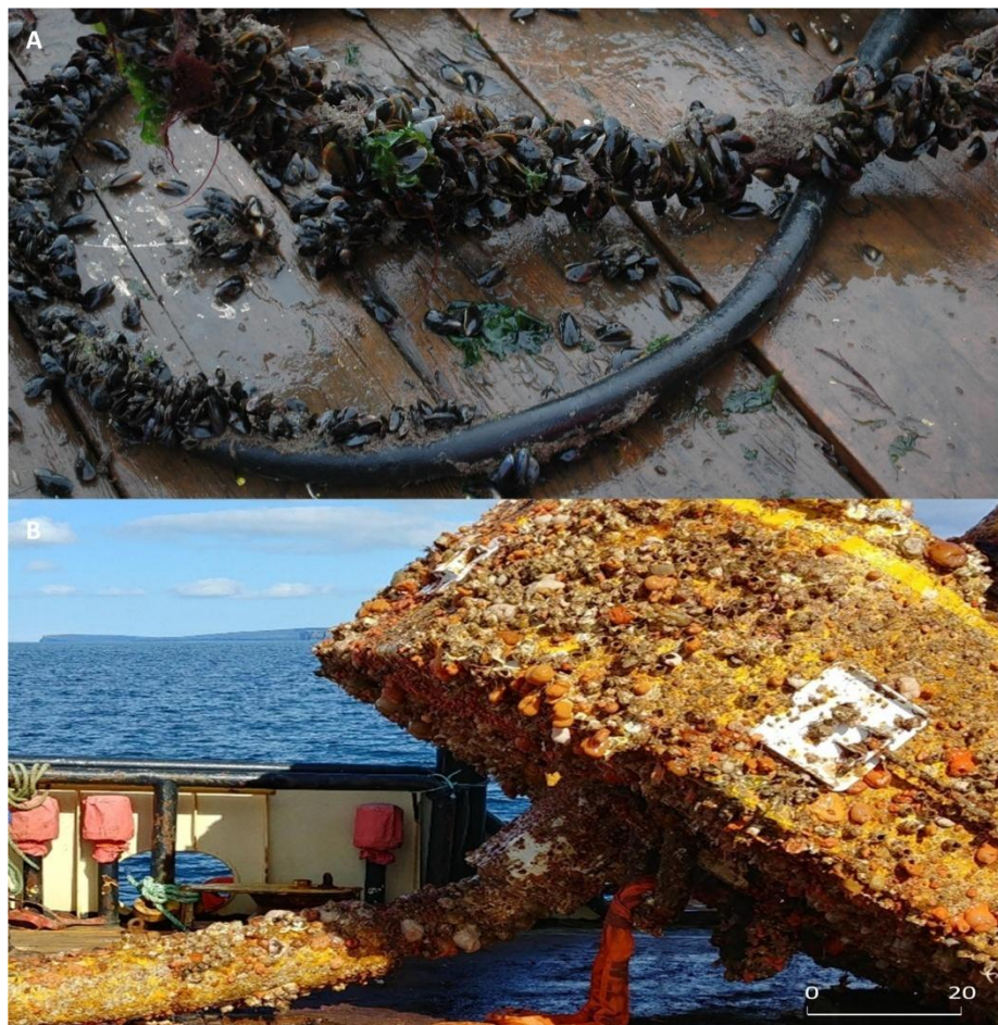
Figura 14. A) Bioincrustaciones en un cable submarino tras un periodo de inmersión de seis meses a cinco metros de profundidad en Milford (Reino Unido) (fuente: https://www.fugro.com/news/long-reads/2023/a-closer-look-at-biofouling-on-dynamic-cables-at-floating-wind-farms ); B) biofouling en el sistema de amarre de un dispositivo de conversión de la energía de las olas (fuente: Want et al., 2023).
