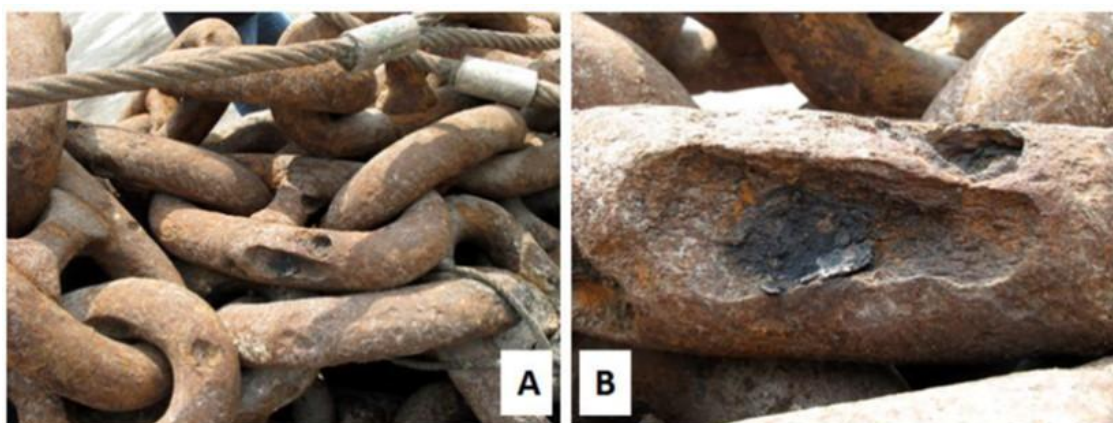
Figura 16. A) Cadena de amarre que muestra una corrosión extensa y agujeros o cavidades en la superficie del material metálico o megapicaduras; B) detalle de megapicadura (figura obtenida de Witt y Ma, 2016).
