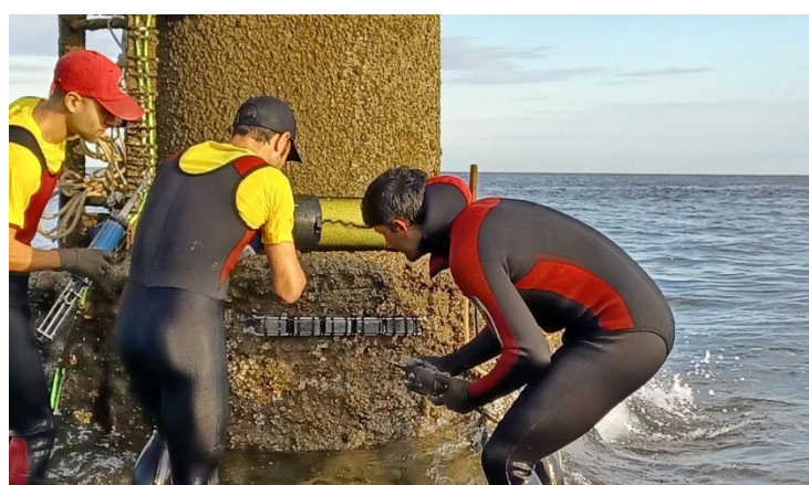
Figura 9. Colocación de las probetas en junio de 2024 en la zona intermareal de la estación océano-meteorológica de Pasaia (Gipuzkoa).
