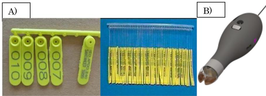
Figura 3. A) Marcas Rototag y spaguetti B) marca MiniPAT utilizadas para el marcado de tiburones en la campaña de 2024.
