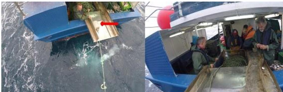
Figura 12. Imagen de la rampa de largado en el momento en el que la piedra de fondeo, indicada con una flecha roja, es arrastrada por el calamento (Imagen izquierda). Encebando los anzuelos a medida que el palangre va saliendo por la rampa (Imagen derecha).
