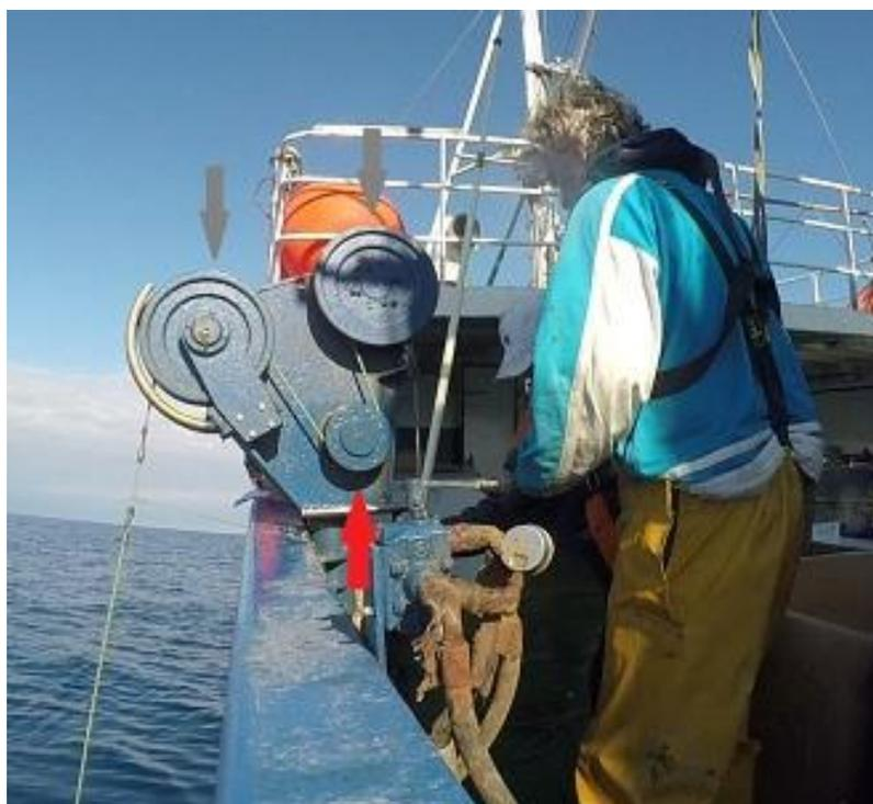
Figura 13. Imagen del halador donde se aprecian los dos platos hidráulicos (indicados por flechas de color gris) y el rodillo (Flecha de color rojo).
