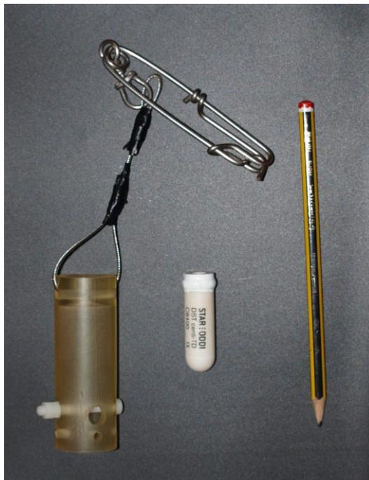
Figura 11. Sensor DST y cilindro protector con el sistema sujeción a la línea madre.
