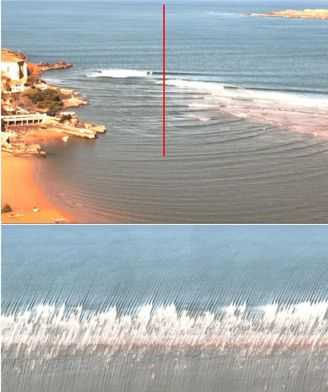
**Figura 1.** Ejemplo de imagen timestack obtenida por el sistema Kostasystem en Mundaka. En la parte superior se muestra en rojo el perfil definido para el procesado y en la parte inferior la timestack generada para el seguimiento de las características del oleaje.
