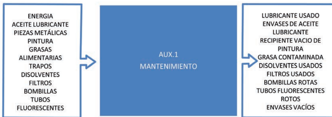
Figura 3. Diagrama de flujo del proceso de mantenimiento
