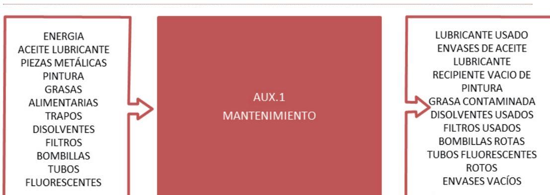
Figura 3. Diagrama de flujo del proceso de mantenimiento
