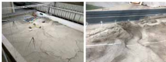
Figura 4. Reproducción de la compleja batimetría en el modelo físico.
