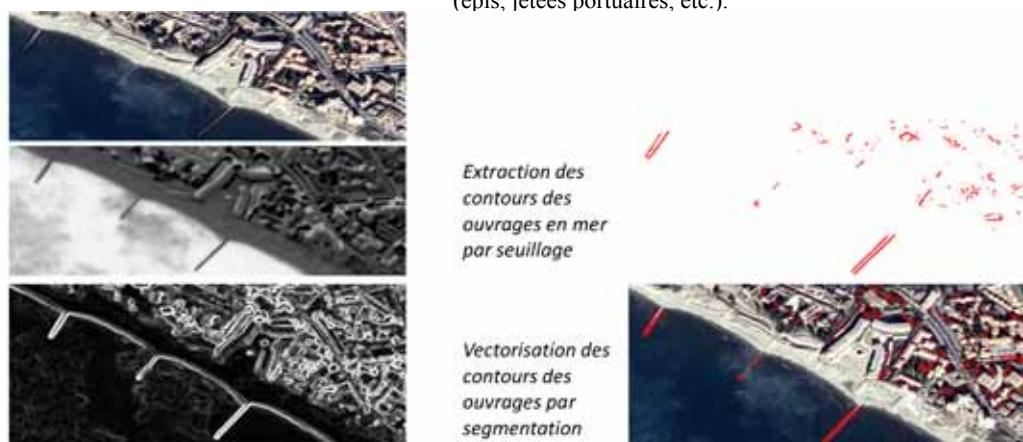
Figure 1. Méthodologie pour extraire les « ouvrages » du trait de côte (en particulier, ceux en contact avec la mer), à partir d'images satellites à très haute résolution spatiale. La mise en œuvre de cette méthode sur des sites tests a permis d'évaluer sa transférabilité géographique ainsi que le déploiement sur un grand linéaire côtier
