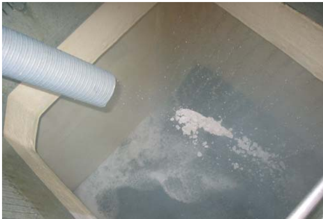
Figura 5. Manguera del sistema de transporte neumático de hielo vertiendo hielo en el vivero.
