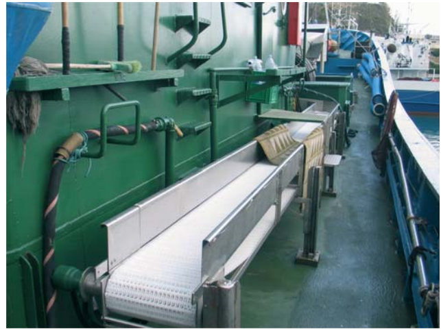
Figura 3. Instalación de la cinta transportadora en el costado de pesca con caña del barco (estribor).
