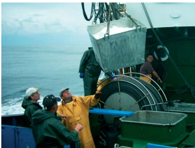
Figura 2. Transporte de hielo desde la nevera al vivero por medio de contenedores para apoyar el enfriamiento de RSW (agua enfriada mecánicamente)
