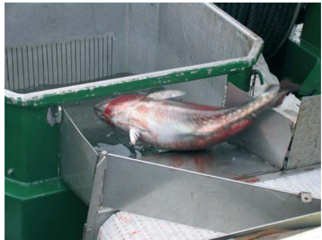
Figura 4. Adaptación de las bocas de los viveros para recoger el pescado desde las cintas transportadoras
