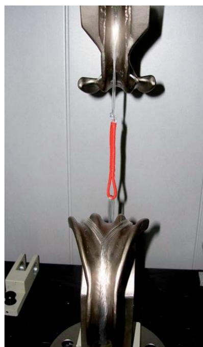
**Figura 8.** Ensayos de resistencia mecánica de los aparejos.
