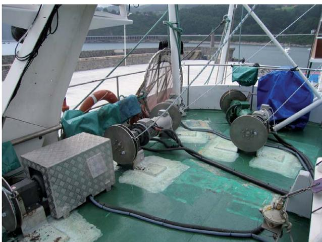
Figura 12. Conjunto motor/reductor y carretel.
