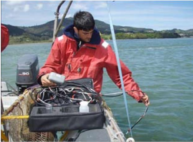
**Figura 4.** Medición de los parámetros oceanográficos (temperatura, salinidad, pH y O<sub>2</sub> disuelto) mediante la sonda YSI 556 (© AZTI-Tecnalia).
