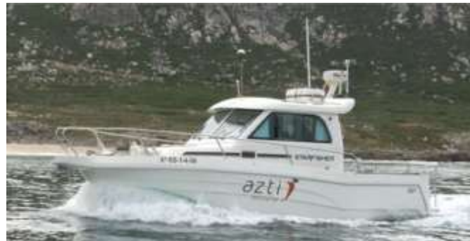
Figura 1. Embarcación AZTIMAR BAT empleada para las tareas de levantamiento batimétrico de alta resolución con ecosonda multihaz.
