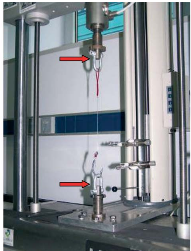
Figura 1. Imagen de la máquina con sus dos posibilidades de enganche: mordazas (Izquierda) y grilletes (Derecha).
