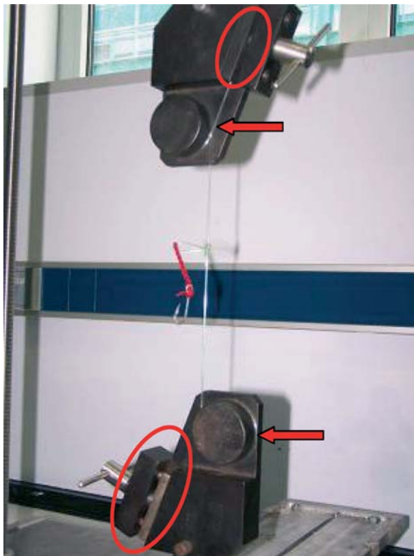
Figura 1. Imagen de la máquina con sus dos posibilidades de enganche: mordazas (Izquierda) y grilletes (Derecha).
