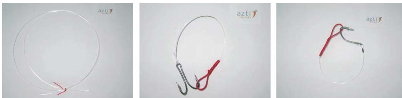
Figura 4. Imagen de las réplicas del aparejo de cacea a bonito. Sin nudo (Arriba izqda.), con nudo (Arriba dcha.) y con remache (Abajo).
